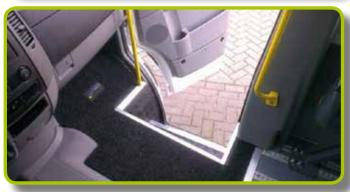
Unter dem Schiebetüreinstieg kann eine elektrische Trittstufe montiert werden, die beim Öffnen der Tür automatisch ausfährt.
