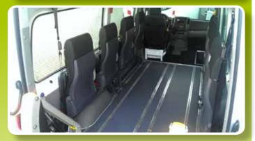
Die Montage der Querschienen auf dem existierenden Boden ist die vorteilhafteste Umrüstung, bei der die vorhanden Fabrikbänke und -Sitze benutzt werden. Der Rollstuhl wird entsprechend der ISO 10542-Norm festgesetzt.
